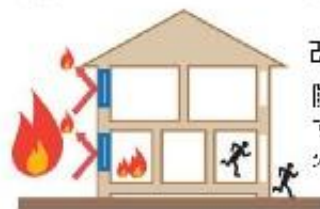
改修前 開口部から建物内 に薪く其に延焼
